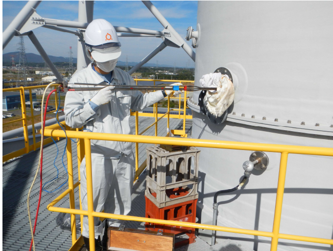
煙道排ガス調査
